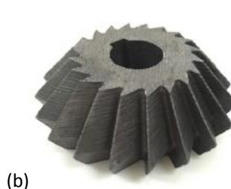
Exemple de composants fabriqués par impression 3D par extrusion (a) en céramique et (b) en carbure
