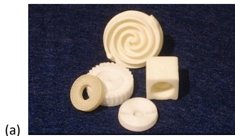
Exemple de composants fabriqués par impression 3D par extrusion (a) en céramique et (b) en carbure
